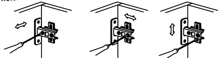
Регулировка вперед-назад. Регулируется крепежным винтом
